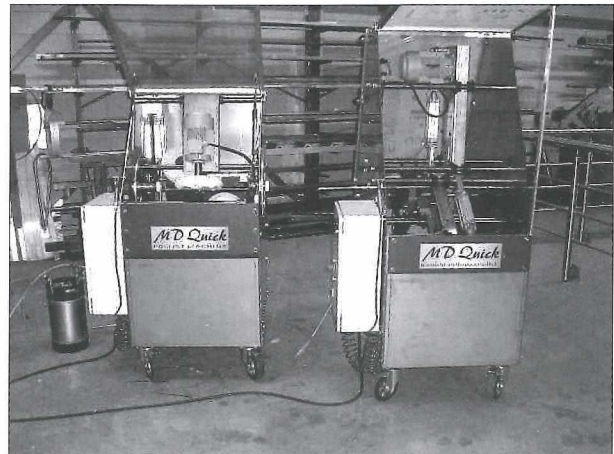
Afb. 11: MD-Techniek, machines voor schuren en polijsten van rod rigging.
