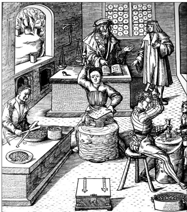
Afb.4: Muntslag in een werkplaats vóór de komst van de schroefpers (ca. 1590).
