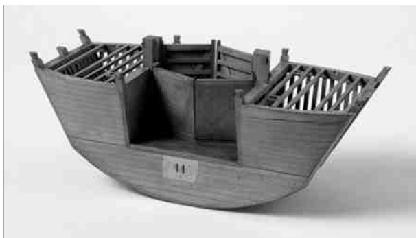
Afb.3: Model (deels opengewerkt) van een schipsluisdeur zoals in Medemblik gebouwd en in bedrijf geweest.
