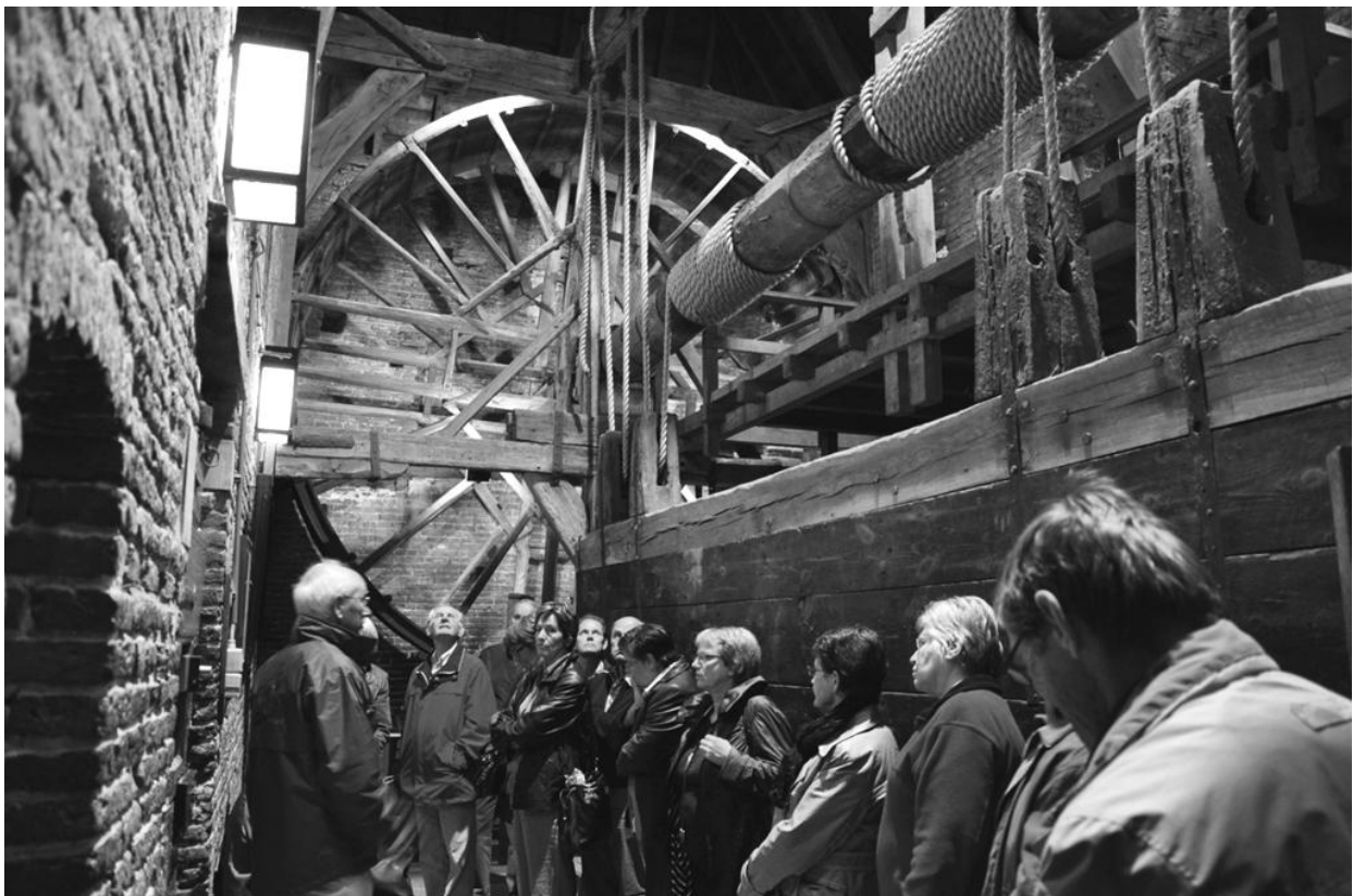
Afb. 1: Binnenzijde van de Koppelpoort met de tredmolen op de achtergrond (foto Arnold de Greeuw).
