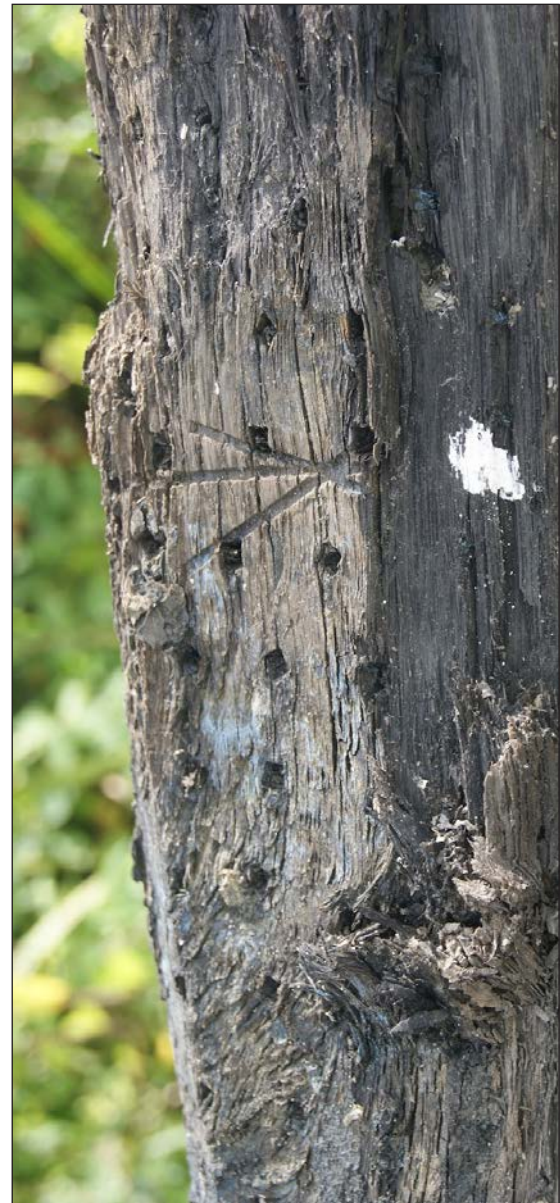
Afb. 16 Paalkop met gezaagd merk.
