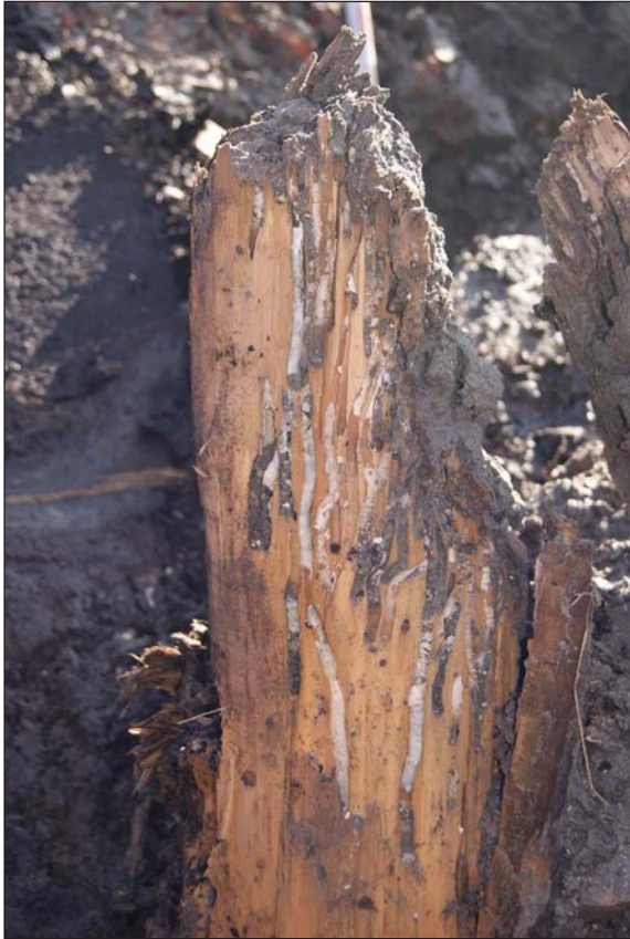
Afb. 27 Een grenen paal met resten van de paalworm, onderzoek 2010 Westfriese Omringdijk nabij Wijdenes. De witte buisjes zijn de kalhulsjes waar de worm in leefde.
