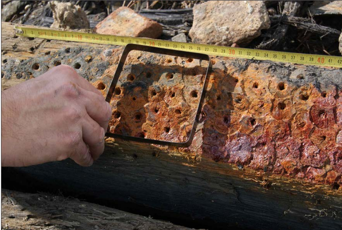
Afb. 10 De palen worden gemeten met het stalen meetraam van 100 cm 2 .
