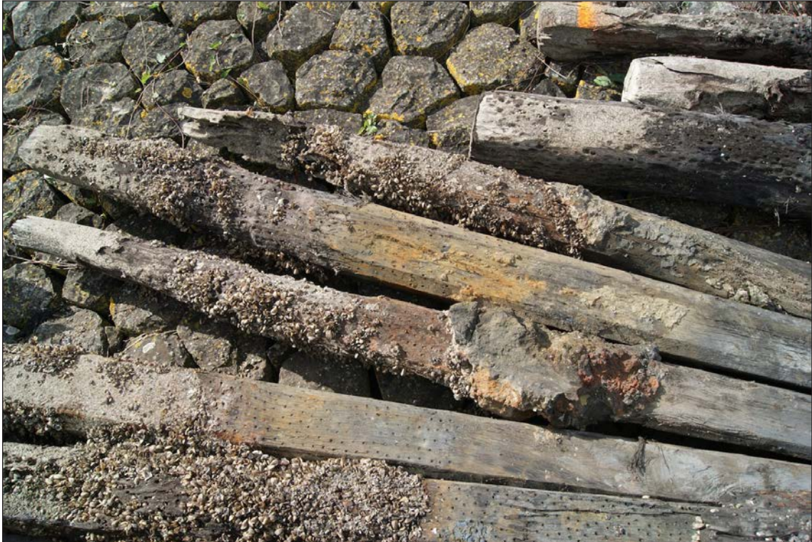
Afb. 11 Een collectie wormspijkerpalen met afgekapte koppen, aangroei van zoetwatermosselen en aangesmeerde pek.
