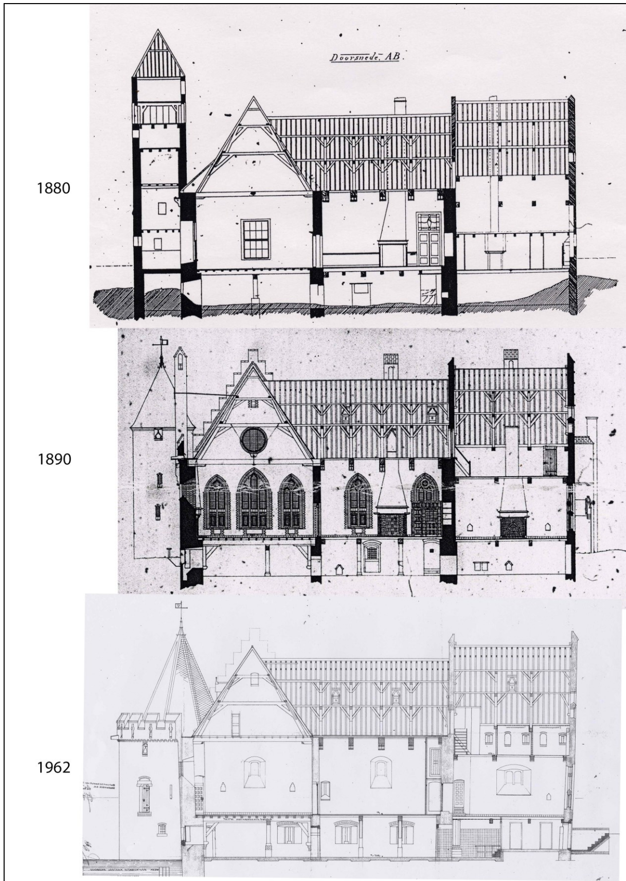
Afbeelding 7. Kasteel Radboud gezien vanuit het zuiden, 1885 (bron: Westfries Archief). De situatie van de kelders voor en na de laatste grote verbouwingen. Helemaal boven de situatie in 1880 (vergelijk met afb. 6), in het midden na de restauratie van 1890-1897 en onder na de restauratie van 1962. De afbeelding uit 1962 is gespiegeld om vergelijking te vergemakkelijken (bron: NA).
